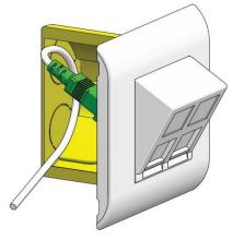
L'installation de la prise box opérateur en ambiance peut se faire sur boite d'encastrement de profondeur 40 mm, mais la profondeur conseillée pour une installation confortable est 50 mm.
